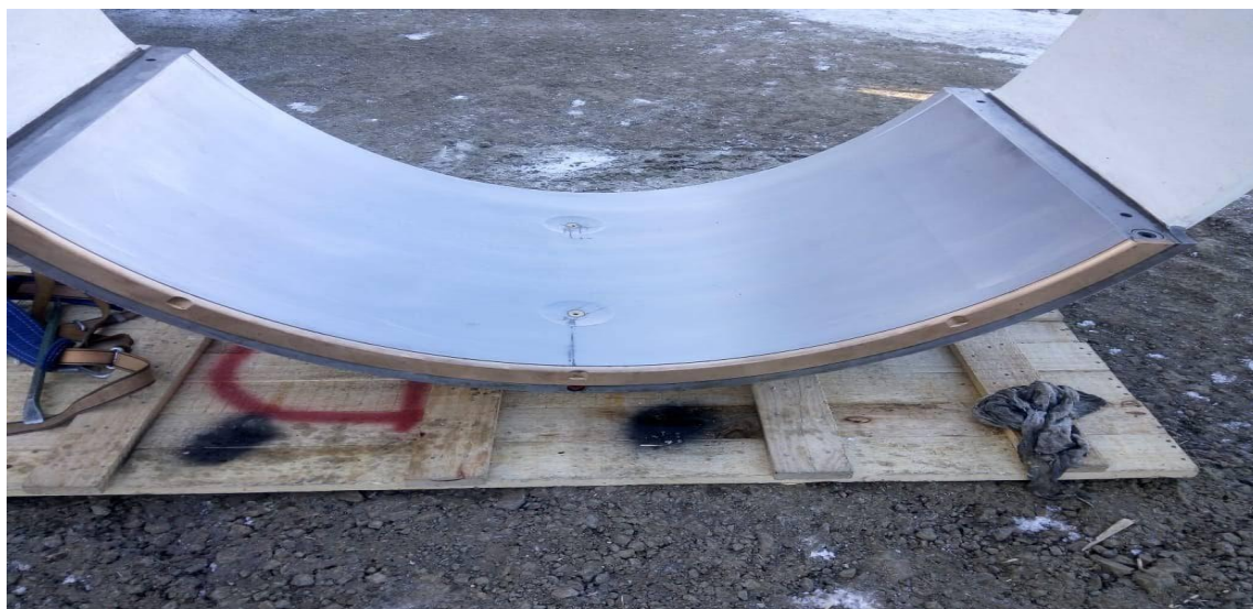
3 Сурет – Қола материалдан жасалған мойынтірек
